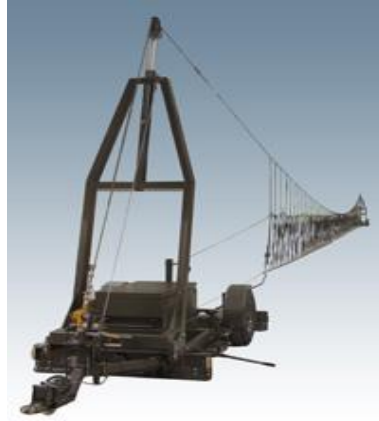
Slika 9: Pehvaćanje bespilotne letjelice u okomito postavljenu mrežu [21]
